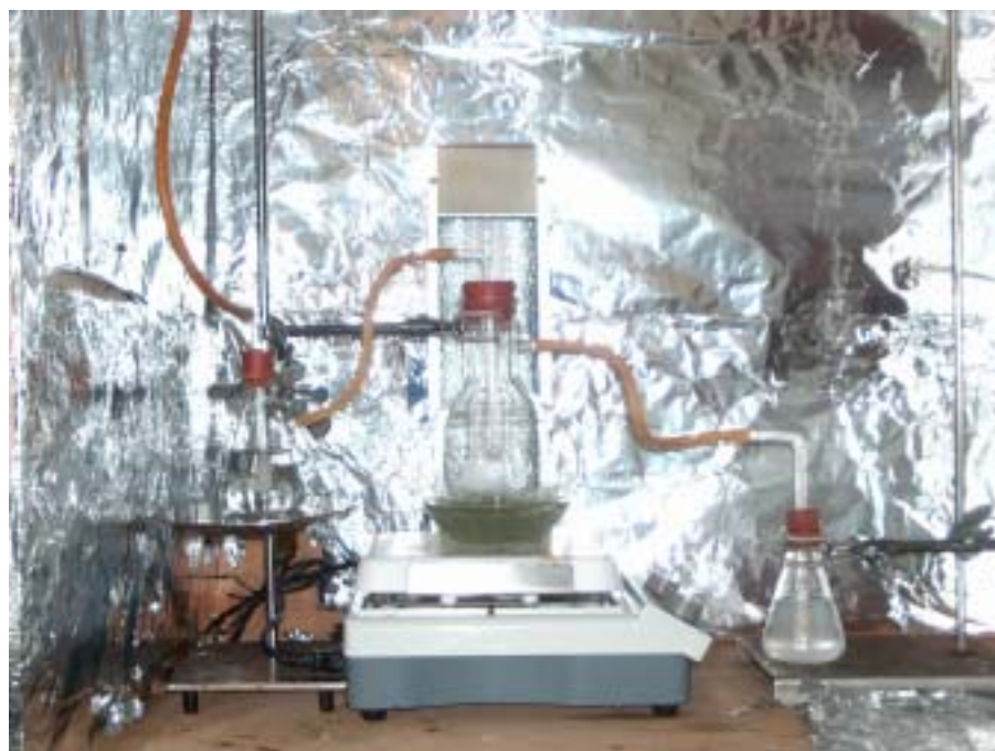
二氧化鈦奈米管玻璃球分解汽油裝置照片(左瓶內為水，右瓶內為 \text{Ba}(\text{OH})_2 溶液)
