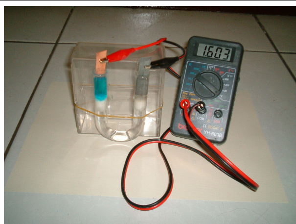
以改良式簡易型實驗裝置，測試陽極為 10M 氫氧化鉀溶液時之電壓。
