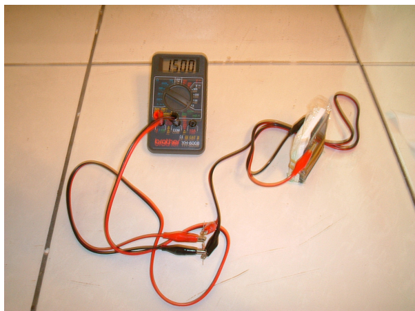
12Ω 負載下，自製電池之輸出電壓。
