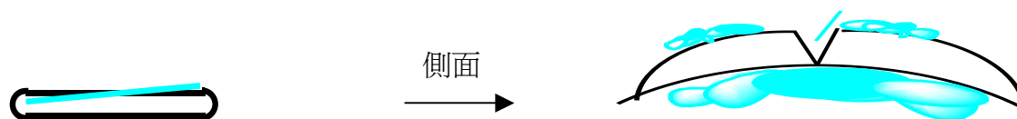
圖 16、金屬片造成晶種的過程
