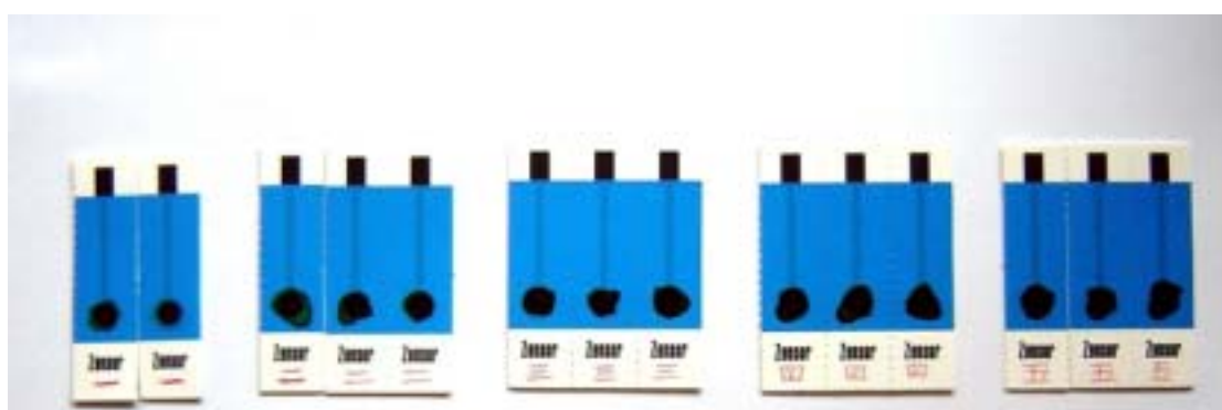
照片二、胡瓜葉萃取液修飾電極
