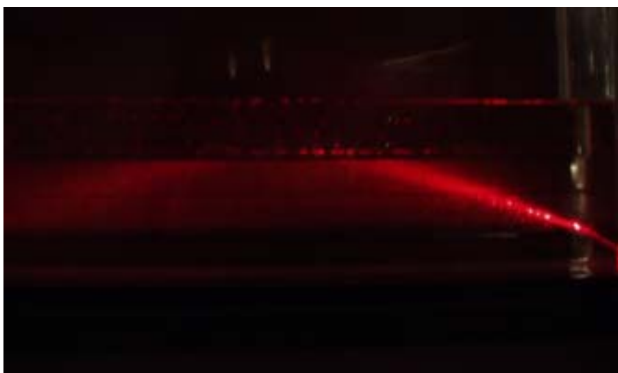
圖十三 雷射光在水和沙拉油的面就產生全反射的光路徑。
