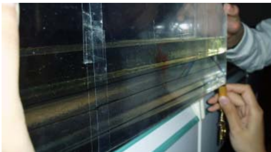
圖十二 由下而上依序為：甘油、漿糊、水、沙拉油之實際分層情形。
