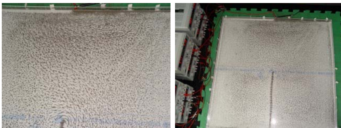
照片(三)在鋁片一邊及中央通入直流電、鋁片上方鐵粉分佈
