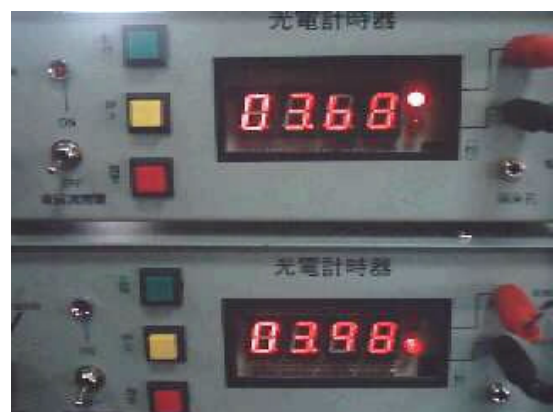
↑ 計時器裝置。任一臺的啓動組會對應到另一臺之停止組（外接光感應器，下頁說明）。此圖中，上面那臺的停止組（黑色接頭）與下面那臺的啓動組（紅色接頭）便是「光阻斷」（可由紅色 LED 判斷）。
