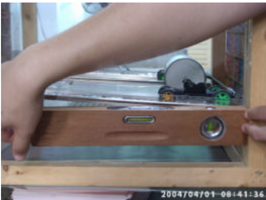
圖 7 用水平儀找水平線
