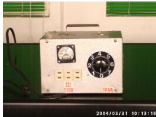
圖 5 調整風扇電壓的大理石變壓器
