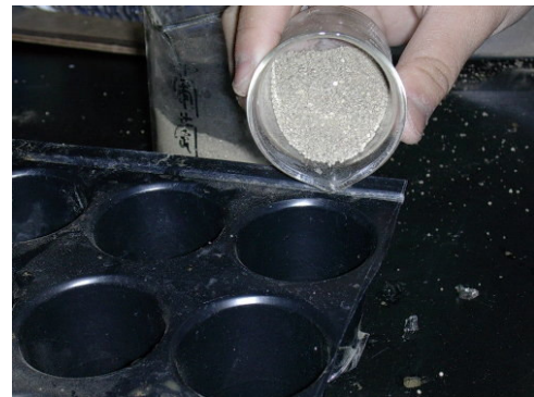
圖(八) 將混合的塑膠土與砂土倒入
