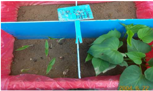
圖（十七）3/4 塑膠土 1/4 砂土植物發芽情形
