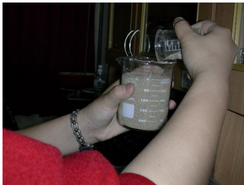
圖(五) 混合定量的砂與土
