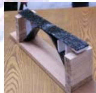
圖十一、圖十二：製作碳纖維橋作承重比較。
