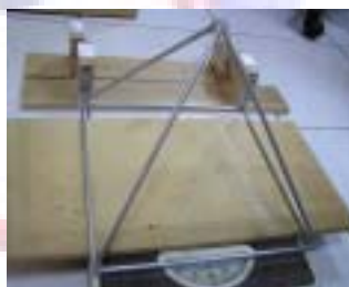
圖十四：製作鋁管金字塔作承重實驗。
