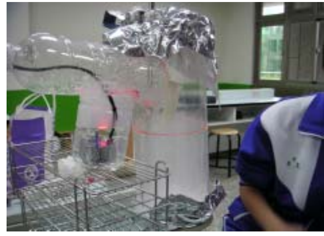
【說明】將凝結核黏在泡棉膠上實驗。觀察並測量其吸水效果。
