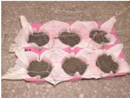
7 將細砂一勺加到各凹槽內，並以相同水量濕潤
