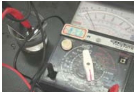
以三用電錶測各不同濃度的鹽水電阻大小
