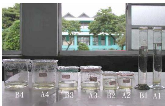
圖 7 進行液面開口大小對藻類沈澱的影響實驗
