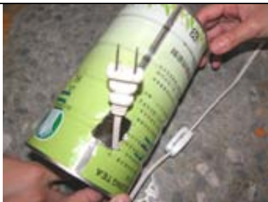
將燈泡座的插頭穿過小茶葉罐底所自己釘打的洞
