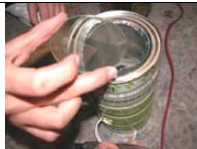
凸透鏡放置在小茶葉罐頂上套在小茶葉罐上
