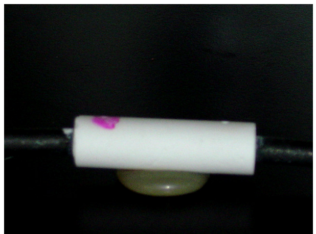
(圖二五) 電解後，負極形成粉紅色，表示負極電解過程形成鹼。
