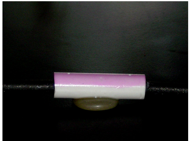
(圖二一) 以 NaOH 爲電解液，水彩筆沾酚酞畫上整上粉筆，顯示粉紅色的鹼性反應。
