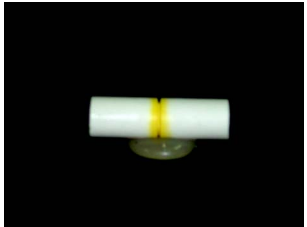
(圖十一) 通電前 \text{K}_2\text{Cr}_2\text{O}_7 於粉筆中線，電解液為 \text{NaOH} ，使橙色 \text{K}_2\text{Cr}_2\text{O}_7 成為黃色 \text{K}_2\text{CrO}_4 。
