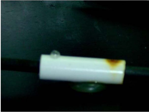
(圖二六) 電解 KI 水溶液，正極形成棕色，負極產生氫氣泡。
