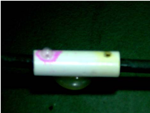
(圖二八) 電解 KBr 水溶液，正極產生淡黃綠色。負極如同電解水反應。
