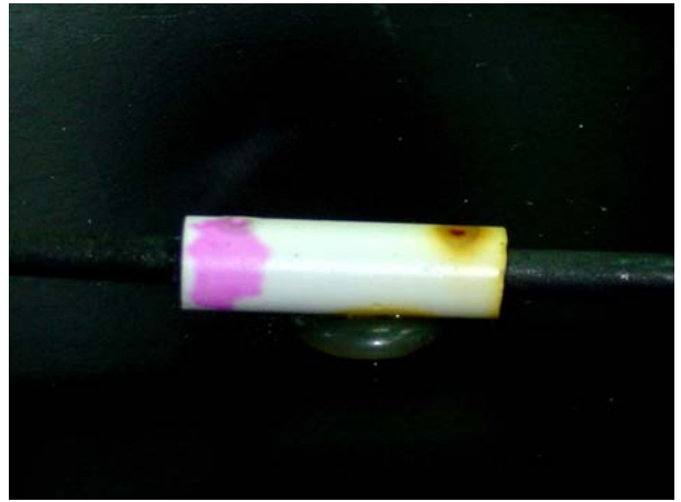
(圖二七) 電解後，負極以酚酞測試，產生粉紅色，為鹼性反應，負極反應如同電解水。
