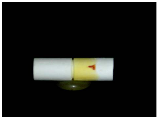
(圖十三) 通電完成以水彩筆沾 \text{AgNO}_3 水溶液，由外而內輕輕一劃，顯示 \text{Ag}_2\text{CrO}_4 磚紅色，利於觀察與測量。
