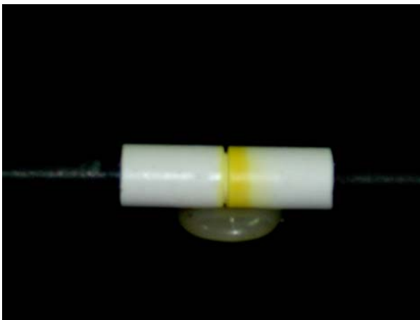
(圖十二) 通電中 \text{CrO}_4^{2-} 黃色向右邊正極移動。
