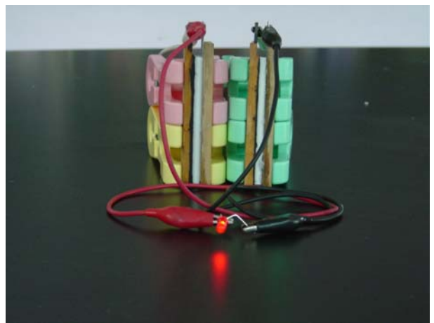
(圖三七) 串聯兩組鹼性電池，使燈泡發亮。
