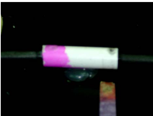
(圖三十) 電解 KCl 水溶液，正極產生酸性反應，藍色石蕊試紙變成紅色，負極如同電解水反應。
