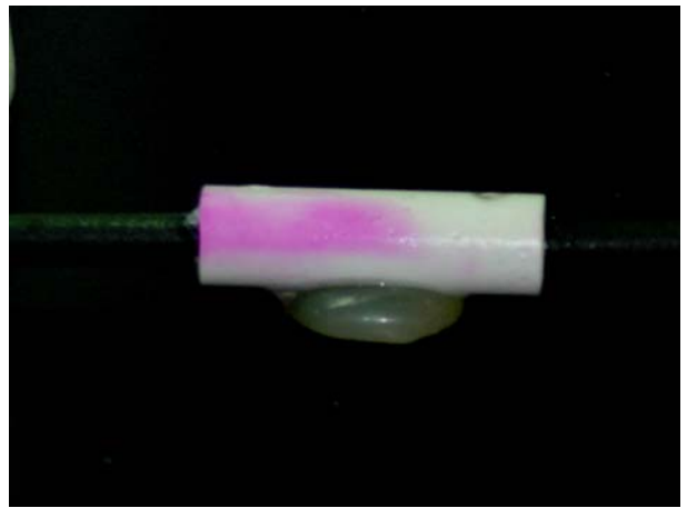
(圖二三) 電解後，正極產生的酸，中和鹼使粉紅色消失。
