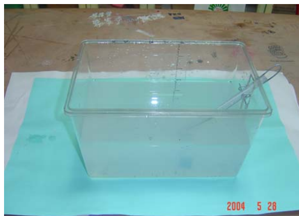
圖十九 鍍銀過程 鍍銀使用硝酸銀水溶液 \text{AgNO}_3 ，呈混濁。
