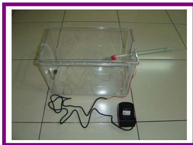
圖二十三 簡易質量電鍍器之側面圖
