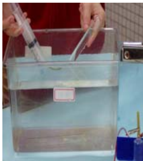
圖 5：利用排水集氣法，將大注射筒抽取的氣體注入試管中收集。
