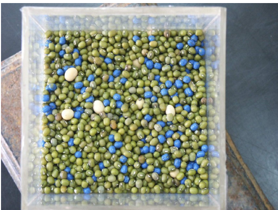
圖 4：振動 40 次後，已上浮黃豆分布情形。
