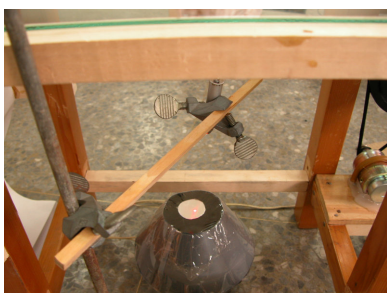
以鐵架鐵夾固定光筆以免晃動
