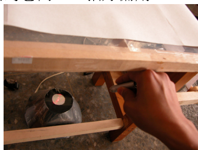
手拿雷射筆向喇叭上的光碟片照射
