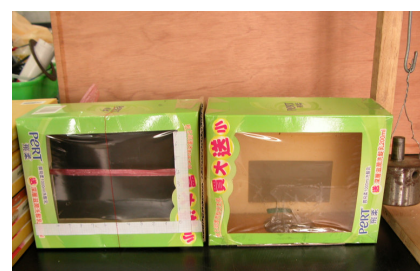
右側為煙箱，左側為集煙箱，拉動左側的繩子，中間的孔洞是煙向左移動的通道
