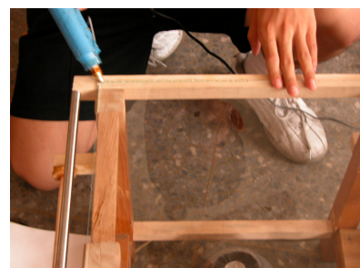
木支架承接玻璃平板
