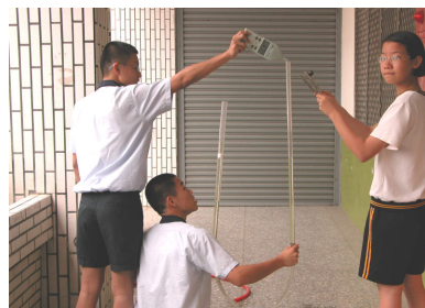
實測空氣柱共振的情形
