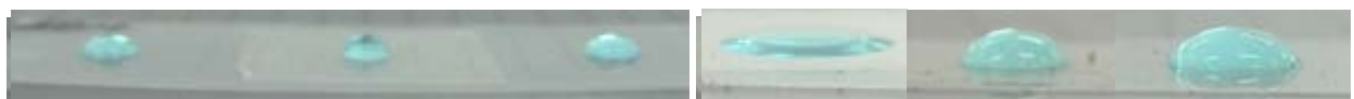
1.0M 硫酸銅液滴在玻片、雙面膠、投影片上的表面張力比較 一小時後的情形
