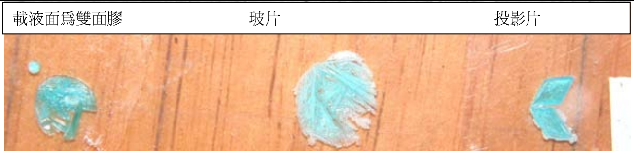
1M 一滴硫酸銅溶液在不同載液面下受連續【NN 同名極】【間距小】磁場下常溫結晶的影響
