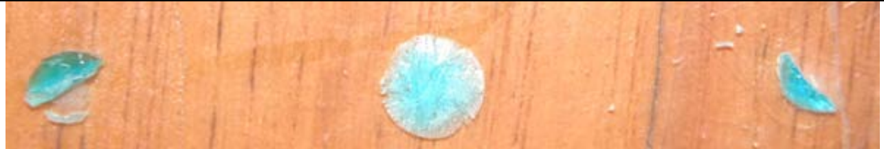
1M 一滴硫酸銅溶液在不同載液面下受連續【NN 同名極】【間距小】磁場下常溫結晶的影響
