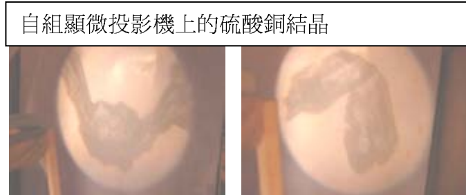
玻片上的結晶較為分散 投影片上的結晶較為集中
