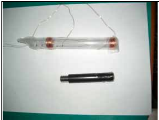
照片三 中空塑膠硬管，管子上纏繞銅漆包線二個，下方為強力磁鐵套在黑色塑膠管上
