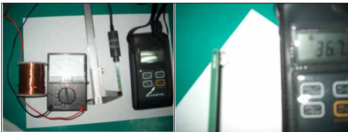
照片八：左一為 0.45mm 的銅質漆包線圈、左二為三用電表、左三為游標尺、右二為測磁儀探針、右一為測磁儀主體
