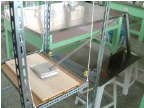
照片一：自製表面張力測定儀。
