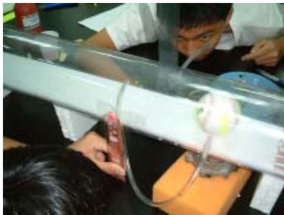
照片十三：壓力差的測量
