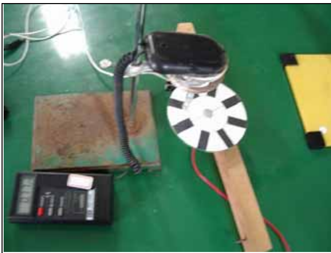
1 以光度計測量反射光強度
