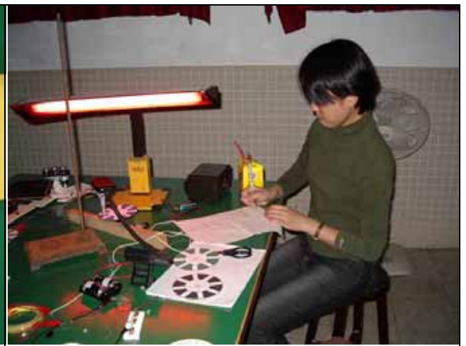
2.改變光源顏色，再以光度計測量反射光強度
