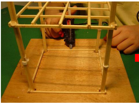
(十)將地樑與木板黏合，並將4洞灌滿熱熔膠固定。(十一)將質量塊盒固定在二、三、四樓板中央。
