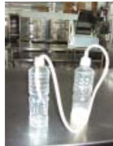
i. 將橡皮管另外一端通入生石灰水中
