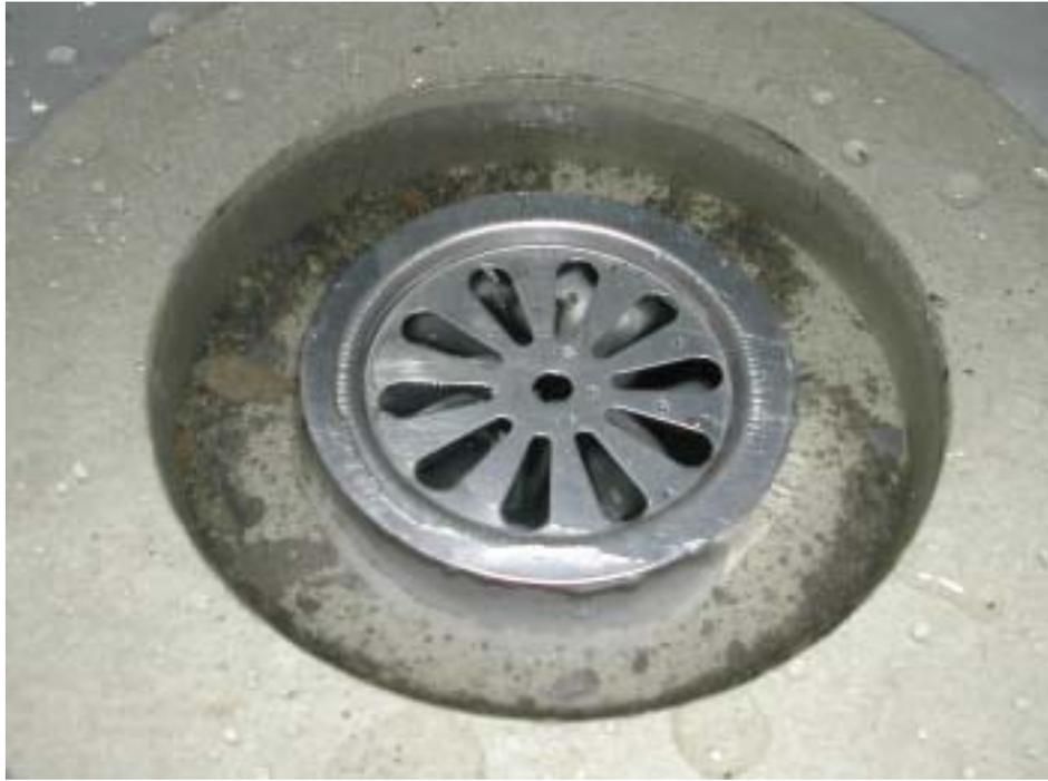
**實驗後，溝槽裡泥沙沉積的情形**
