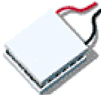
直流電源提供了電子流動所需的能量，通上電源之後，電子由負極(-)出發，首先經過 P 型半導體，於此吸收熱量，到了 N 型半導體，又將熱量放出，每經過一個 NP 模組，就有熱量由一邊被送到另外一邊，造成溫差，而形成冷熱端，冷熱端分別由兩片陶瓷片所構成，冷
