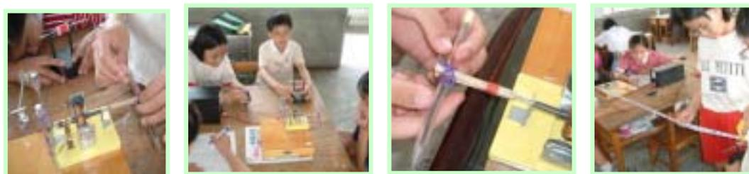
圖 14: 轉軸上綁棉線 圖 15: 轉軸捲線中 圖 16: 邊收線邊算筆轉數 圖 17: 量棉線捲長
