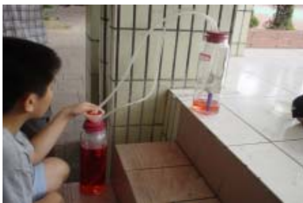
圖二、B 瓶與 A 瓶液面差不同，引泉流速也不相同；如圖位差三階比二階流得更快。
