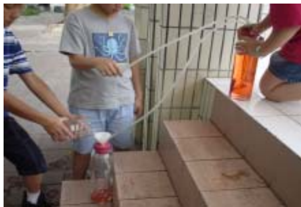
圖二、B 瓶與 A 瓶液面差不同，引泉流速也不相同；如圖位差三階比二階流得更快。
