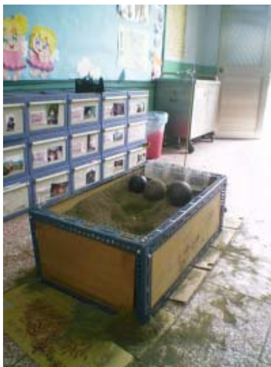
圖 1.製造人工地震的裝置圖
