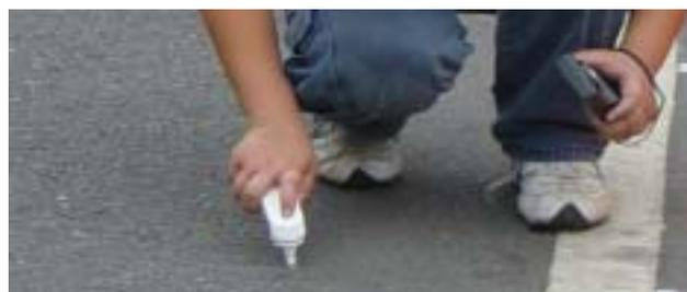
圖（一）E：以耳溫槍測量地溫
