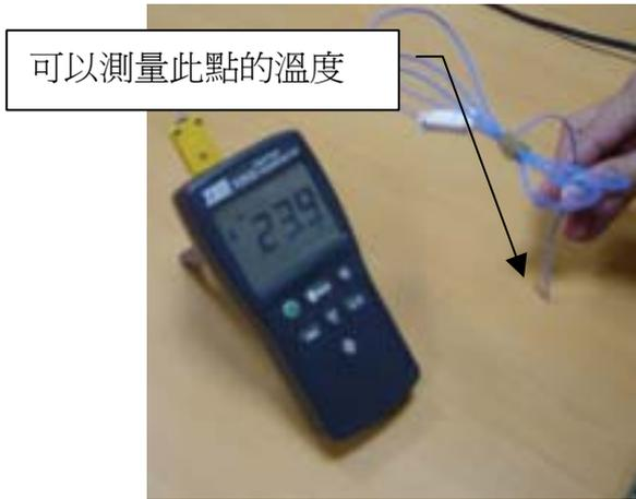
圖（五）A：k-type 溫度計
