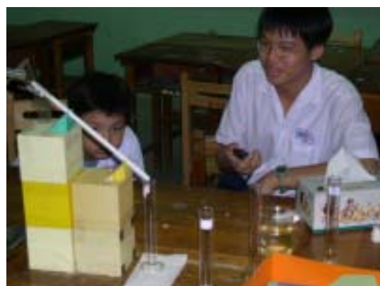
照片十二 測量水、沙拉油和甘油的黏滯性實驗
