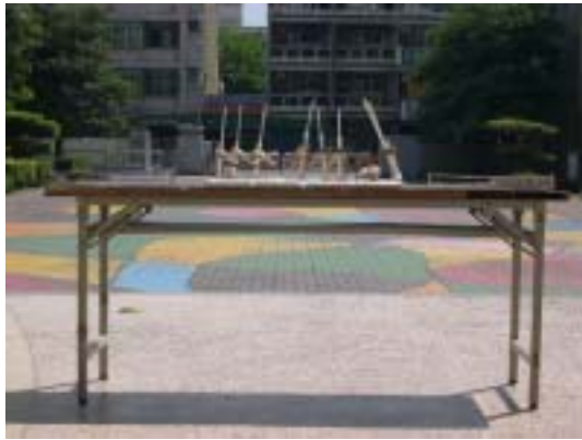
照片五 水、沙拉油和甘油在太陽下受熱實驗裝置
