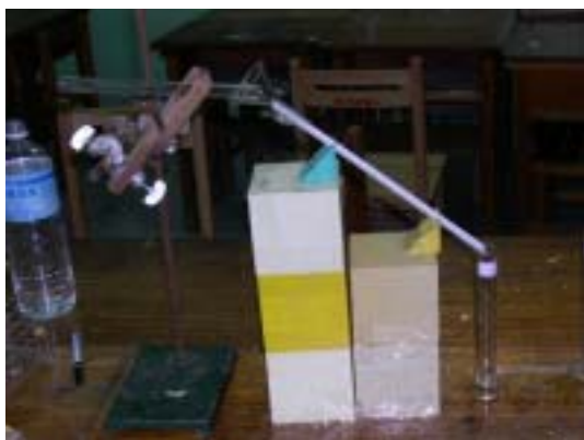
照片十一 測量水、沙拉油和甘油黏滯性大小實驗裝置
