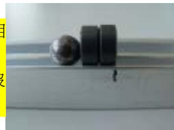
在磁鐵左邊再加 1 顆鋼珠，變成磁鐵左邊有 2 顆鋼珠，重新做實驗，結果磁鐵左邊第 2 顆鋼珠會彈出來，但是彈出來的速度很慢很慢，重複做了幾次，有時彈出來的鋼珠還沒撞到左邊的磁鐵就停止了，速度就是沒辦法像使用釹鐵硼磁鐵時那麼快，所以就算造成鋼珠加速，最後撞到軟片盒的速度也很慢，軟片盒根本沒有移動。
