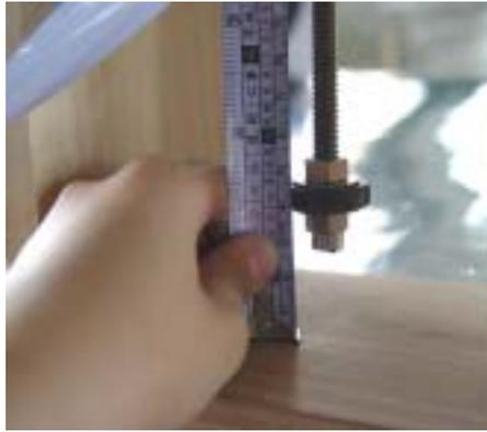
用捲尺量一量下面磁鐵被吸上來的一瞬間，下面那顆釹鐵硼磁鐵和上面黑色磁鐵的最近距離。我們的量法是從下面木板的表面，量到上面黑色磁鐵的底部，再減去下面那顆釹鐵硼磁鐵的厚度（0.58cm），就等於是上下兩邊磁鐵的最近距離。
