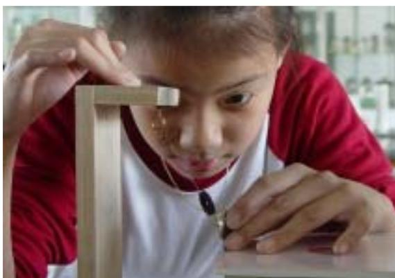
單擺磁鐵受到蠟燭火焰的熱之後，過幾秒鐘就會擺向左邊，再過幾十秒鐘，它又會被吸引，又和火焰接觸，幾秒鐘之後又擺回去。像這樣一直重複發生，在整個過程中，我們完全沒有接電池或馬達，這種磁鐵單擺就可以一直來回擺動。
