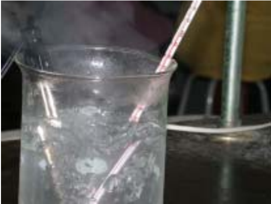
▲溫度計浸泡在電湯匙燒開的水
