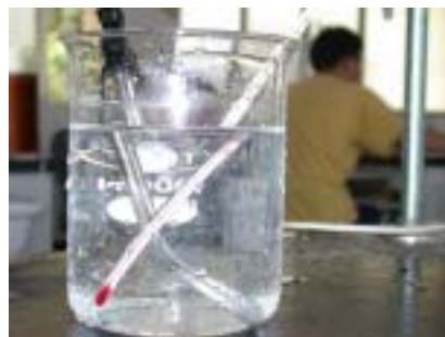
▲用電湯匙將水溫調至與溫排水溫同
