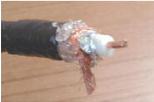
圖十四、待連接餽電元件之同軸電纜
