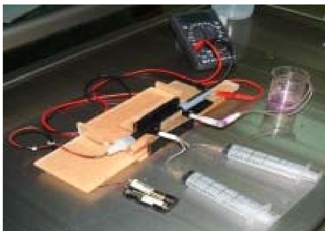
圖五：以壓克力板固定模組式微型化學反應光學偵測裝置
