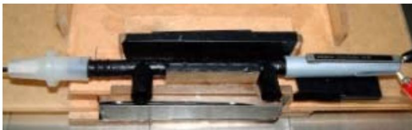
圖二：自製模組式微型化學反應裝置外觀
