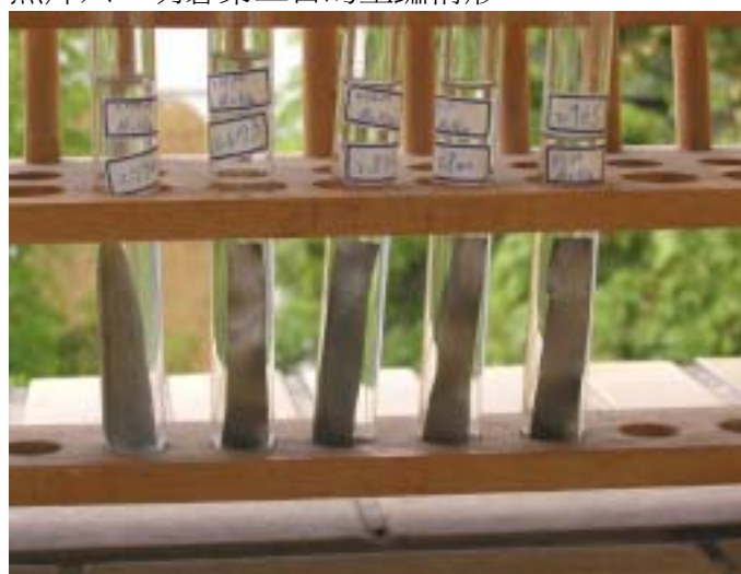
照片八、硫酸鋁第三日的生鏽情形
