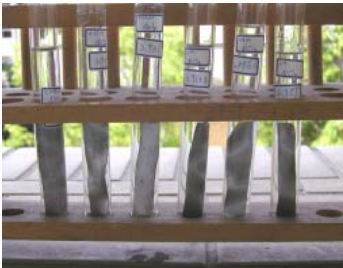
照片十九、氯化鋁第一日的生鏽情形
