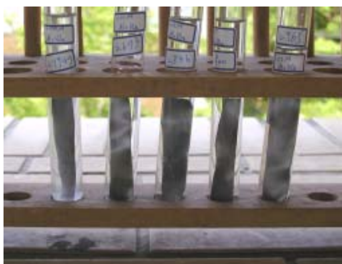
照片七、硫酸鋁第一日的生鏽情形
