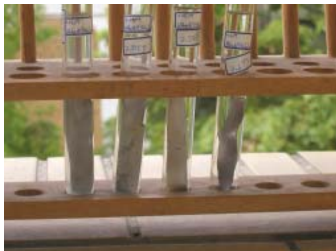
照片二、鋁鉸簪第三天的生鏽情形
