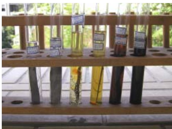
照片九、硝酸鋁第一日的生鏽情形
