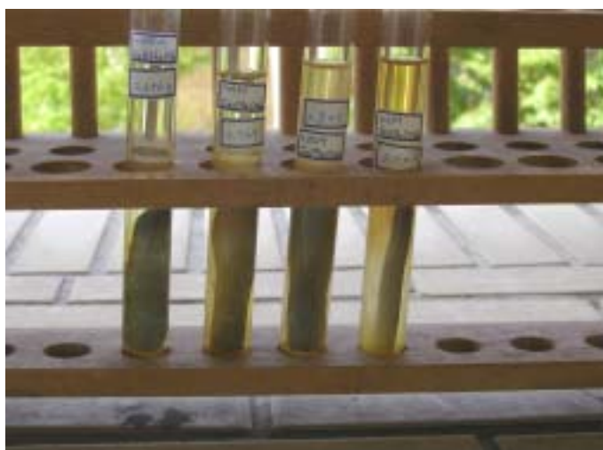
照片三、鐵鉸簪第一日的生鏽情形
