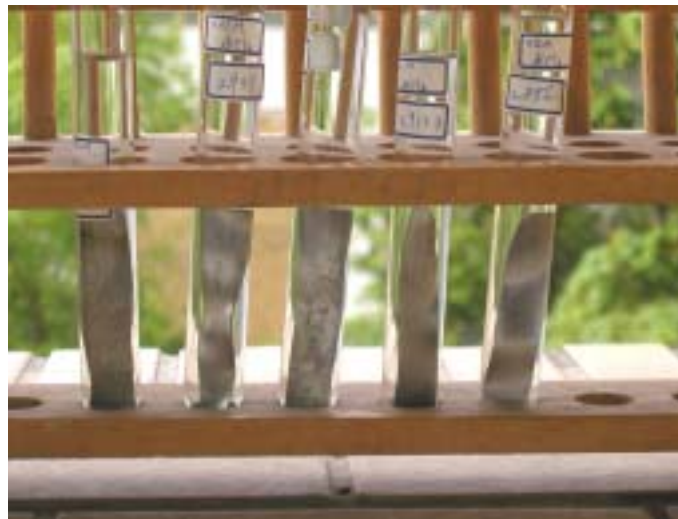
照片二十、氯化鋁第三日的生鏽情形
