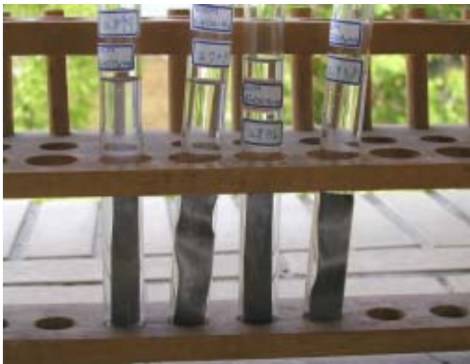
照片十七、鹽基式醋酸鋁第一天生鏽的情形
