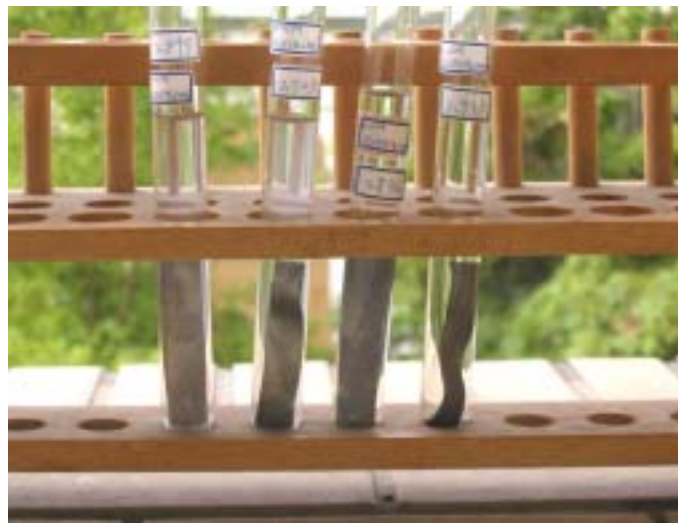
照片十八、鹽基式醋酸鋁第三天生鏽的情形
