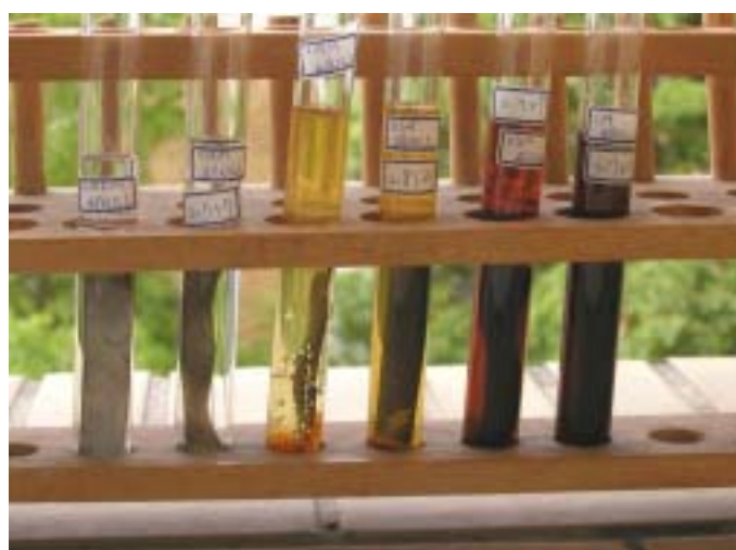
照片十、硝酸鋁第三日的生鏽情形
