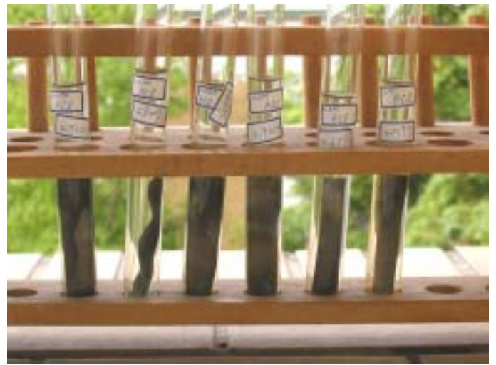
照片十二、氯化鉀溶液第三日的生鏽情形
