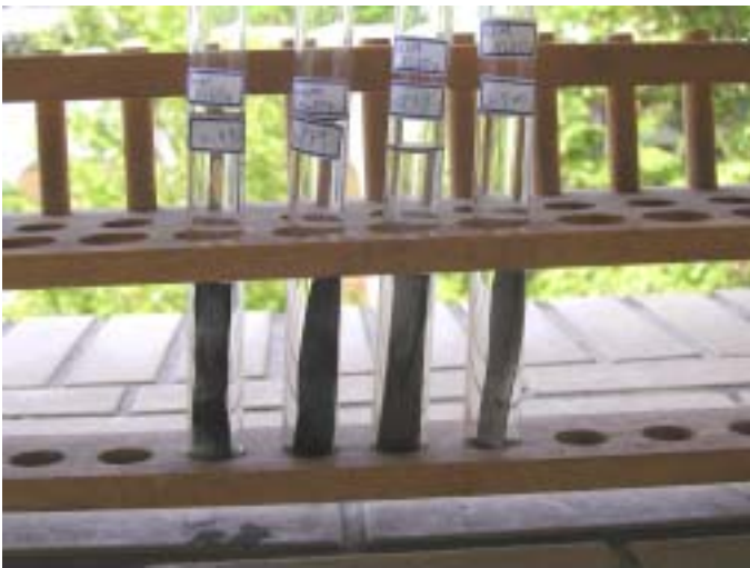
照片十三、硫酸鉀第一日的生鏽情形
