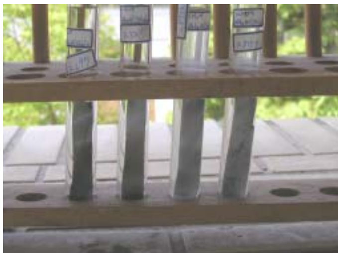
照片一、鋁鉸簪第一天的生鏽情形
