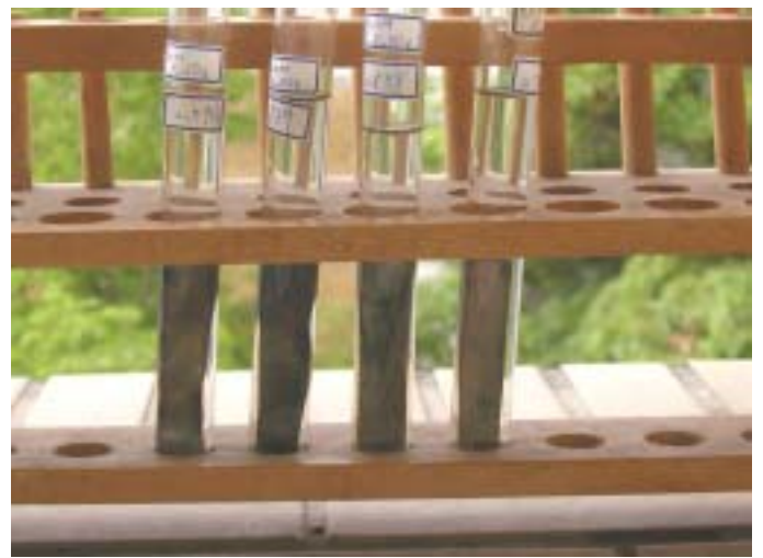
照片十四、硫酸鉀第三日的生鏽情形
