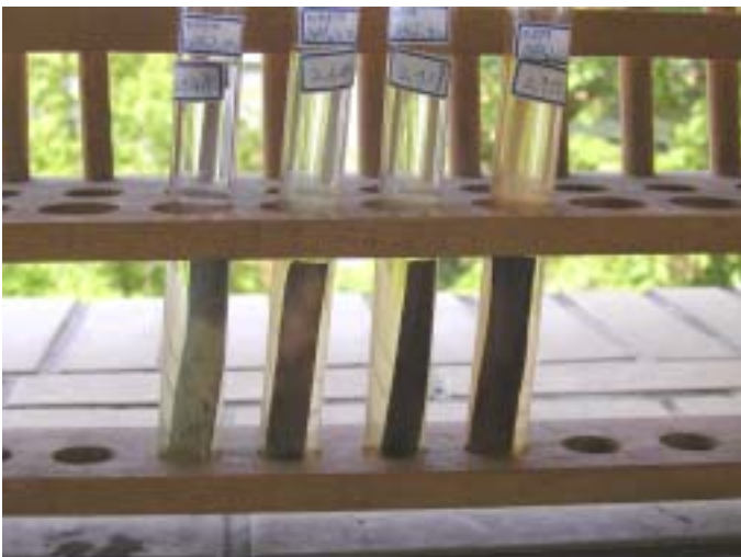
照片十五、硫酸銨第一日生鏽的情形
