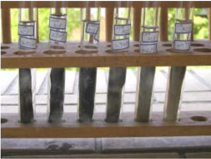
照片十一、氯化鉀溶液第一日的生鏽情形
