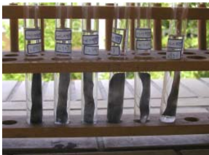
照片五、明礬第一日的生鏽情形
