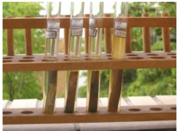
照片十六、硫酸銨第三日的生鏽情形
