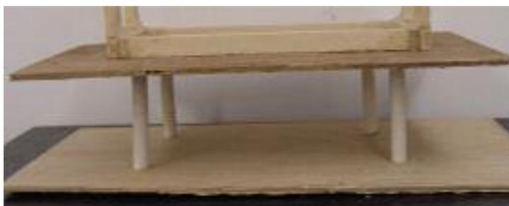
3. 假設：無橡膠柱的衍架，因未有防震措施，而震波回直間傳到衍架上，因此預估其搖擺的幅度最大。反而，以 4.5 橡膠柱作為防震措施的衍架，因為有彈性物質的隔絕，使得能量震波傳達到衍架主體前，其一部分會因橡膠柱的左右位移而消耗掉。因此，搖擺幅度較小。
