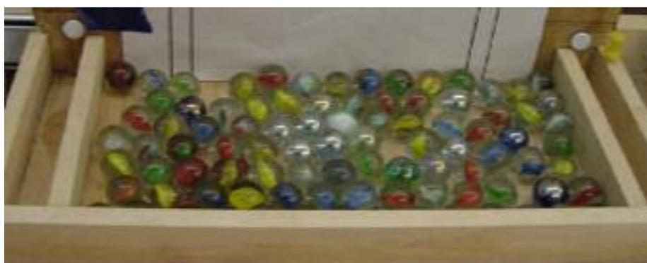
3. 假設：彈珠防震法的原理是應用顆粒狀物質的接觸面小（摩擦力小），在震波抵達時，因建築物的重量向下壓，地表移動時建築物因彈珠的滾動猶如懸浮在半空中一樣，受到的影響想必比橡膠防震法的效率來的好。
