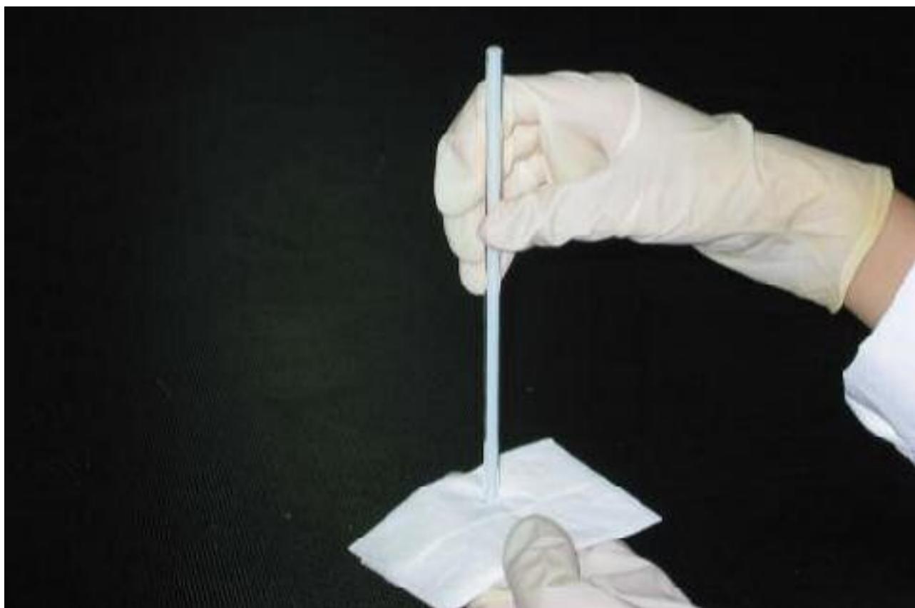
照片八 小心翼翼的擦拭厚毛細管外壁
