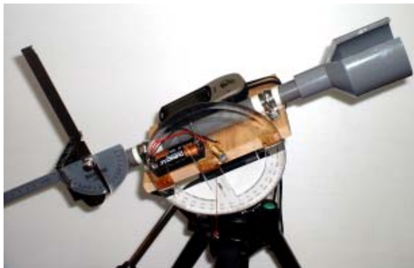
圖 1：第一代至第四代（由左至右、上至下）的自製“天體定位儀”
