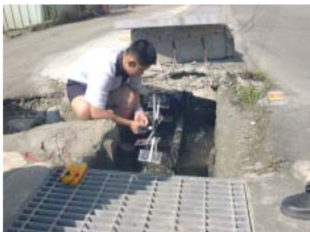
葫蘆墩圳三分水下游約 200m 的地點 2 水流的水力發電實驗(平板狀的壓克力扇葉)
