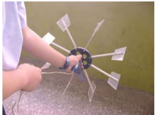
平板狀扇形水車及發電機
