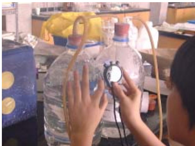
以碼錶定量上瓶每降低 300ml 時的水流時間 水流經橡皮管至接水槽的情形
