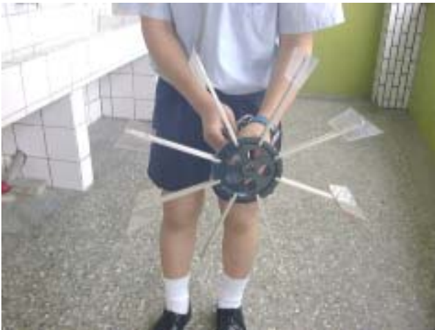
已設計好的梯形壓克力板的水車及發電機
