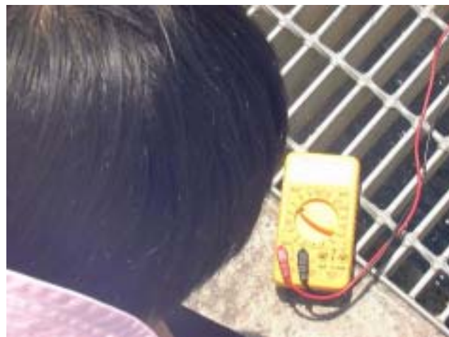
以三用數字型電錶記錄電壓及電流大小
