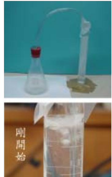
圖三 殼和鹽酸作用使石灰水渾濁
