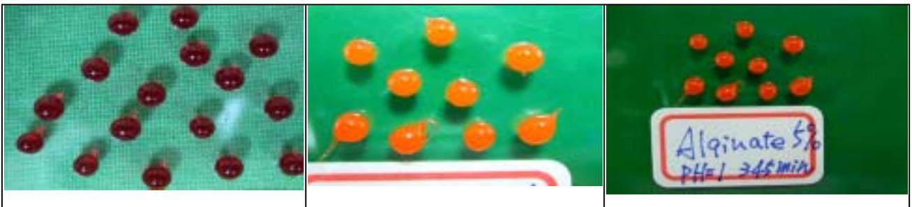
由圖 4-7(a)~(d)可看出，在固定酸鹼值其不同海藻酸鈉濃度所造成的影響，由圖中可更明顯的看出，在 pH 值為 7 時，海藻酸鈉膠球濃度的提高，可加強膠球對於磷酸鹽的抵抗能力，較不易在短時間內脹大、崩解。由此可知，海藻酸膠球的濃度亦會影響其機械性質，通常海藻酸鈉濃度愈高，強度愈佳，這種情況在 pH 值為 9 時，也有相同的結果。在 pH 值為 1 時，其海藻酸鈉濃度的提高對於膠球在酸液中並無太大的變化，每種膠球濃度在浸泡於酸液中，最後所得的重量百分比皆差不多，這可能是因酸液中的氫離子置換了膠球內的鈣離子，造成膠球的球體變小，但是每種濃度的膠球其變小的程度應會有所不同，因為單位體積下海藻酸鈉分子數量若較多，即會佔有一定的空間，所以膠球球體能變小的程度有限，因此被擠出水份也有限，但由於膠球濃度愈高其所鍵結的鈣離子量則愈多，而造成鈣離子被置換出量也愈多，所以，由此可知，在高濃度的膠球球體，其球體變小的程度有限，但鈣離子被置換的量卻較多，反之低濃度的膠球球體，其球體變小的程度較大，但鈣離子被置換的量卻較少，在這兩種因素影響之下，造成每種膠球濃度在浸泡於酸液中，最後所得的重量百分比皆差不多。
