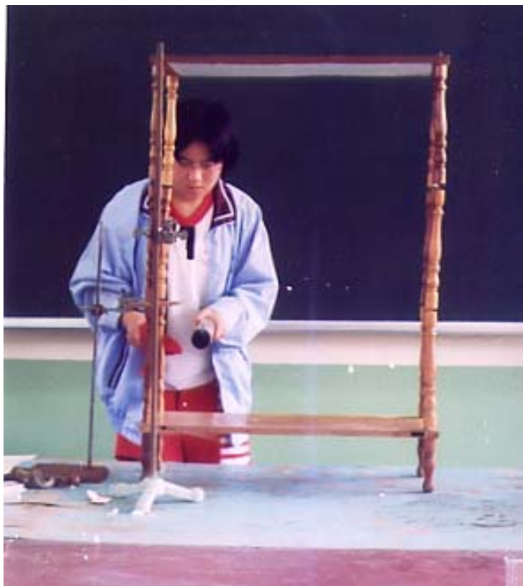
照片 11 黏在木板上的磁片，很容易受帶電的塑膠棒吸引而彎曲。
