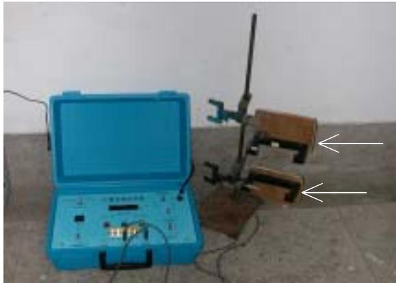
2. 在光電計時器的感應器上貼上一張紙，中間鑽個小洞(如圖六)，使射出的光束變小，可以讓感應器比較靈敏。
