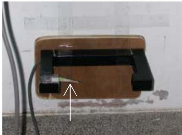
4. 我們把開始和停止兩感應器利用鐵釘嵌入木板中，在 30cm 之內以鐵架及固定夾固定來測量，超過 30cm 就在牆上做刻度，將兩木板貼在牆上測量。
