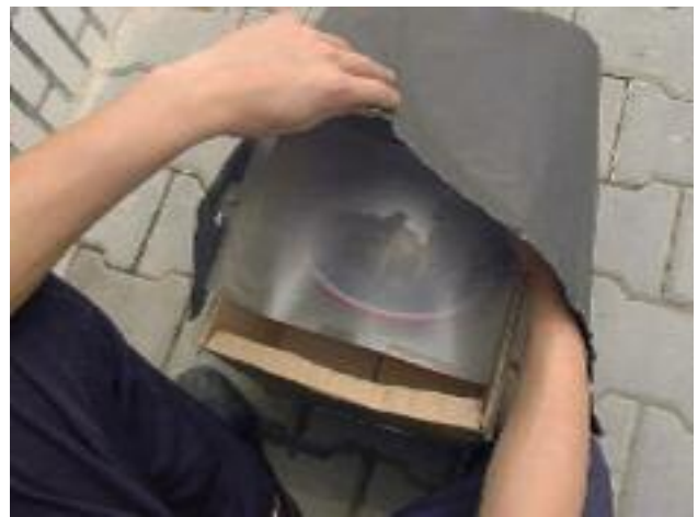
8 一手遮光，一手控制顯影板，已經手忙腳亂了，還要度量像長等數據，實在不方便，準備設計透明刻度片再來測量
