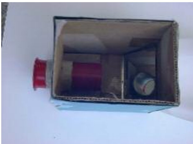
3 光由左側進入凸透鏡頭，而在右側平面鏡中呈像
