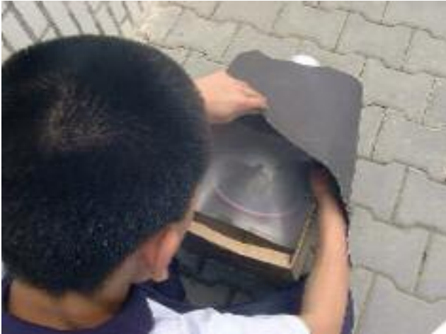
7 第二代素描機以半透明塑膠片為顯影板
