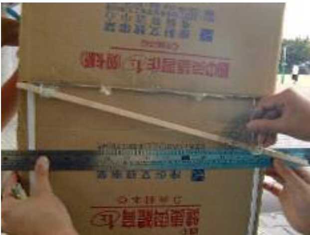
以外控制桿拉動控制線，使內部影像板仰角抬高 15°
