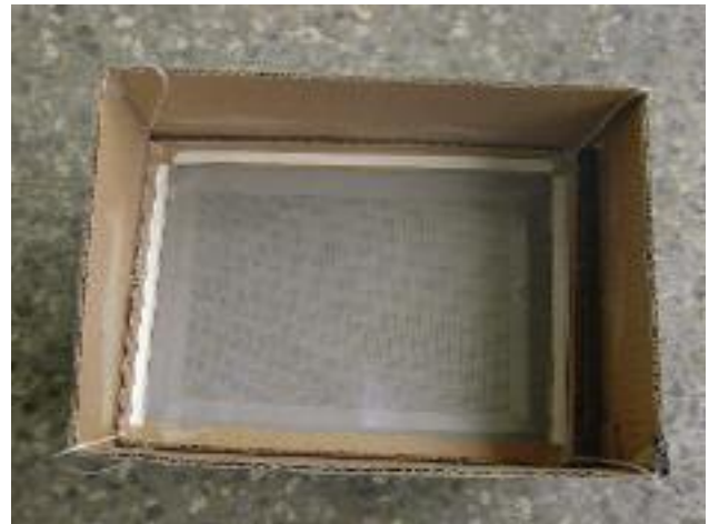
10 投影螢幕加已設計印刷上刻度的投影片 (可直接度量像的長度)
