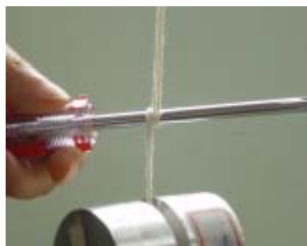
二條拉繩纏繞軸心一圈 \theta = 2\pi 的彈簧秤拉力測試
