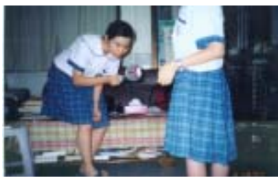
圖九：yoyo 在不同直徑下，以轉速計測試到達底部的旋轉角速度
