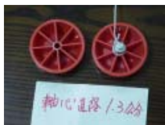
圖 12：圓形輪直徑大小為 6cm 的 yoyo 固定不變，其軸心直徑分別以 0.6cm、1.3cm、1.9cm 的不鏽鋼軸心材質變化
