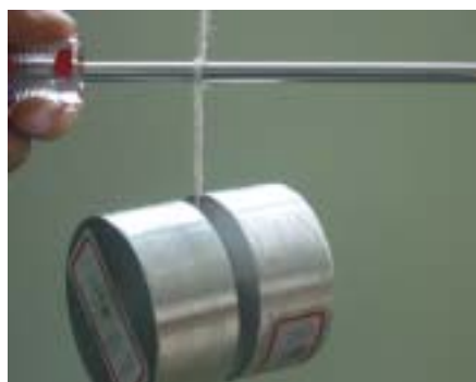
一條拉繩纏繞軸心一圈 \theta = 2\pi 的彈簧秤拉力測試
