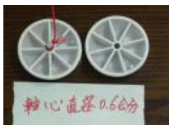
圖 12：圓形輪直徑大小為 6cm 的 yoyo 固定不變，其軸心直徑分別以 0.6cm、1.3cm、1.9cm 的不鏽鋼軸心材質變化
