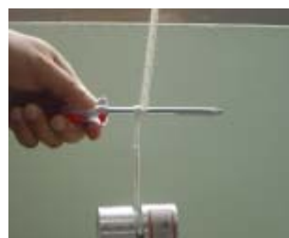
三條拉繩纏繞軸心一圈 \theta = 2\pi 的彈簧秤拉力測試
