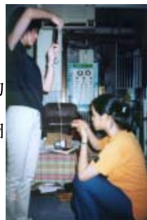
圖四：以彈簧秤測量 yoyo 支撐拉力
