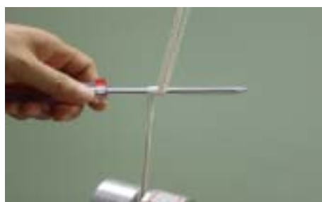
二條拉繩纏繞軸心一圈 \theta = 2\pi 的彈簧秤拉力測試
