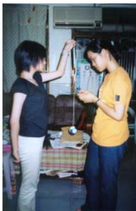
圖 20：用彈簧秤測量 yo yo 支撐拉力
