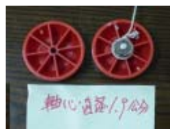
圖 12：圓形輪直徑大小為 6cm 的 yoyo 固定不變，其軸心直徑分別以 0.6cm、1.3cm、1.9cm 的不鏽鋼軸心材質變化
