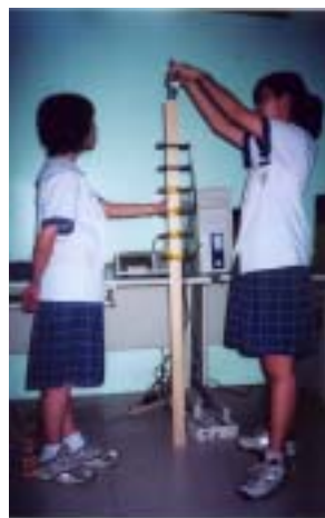
圖十六 Yoyo 從最高位置自由落下，初速度為零，全程 150 公分一路以變加速度運動，最後是否為變減加速度或等加速度運動視軸半徑而定
