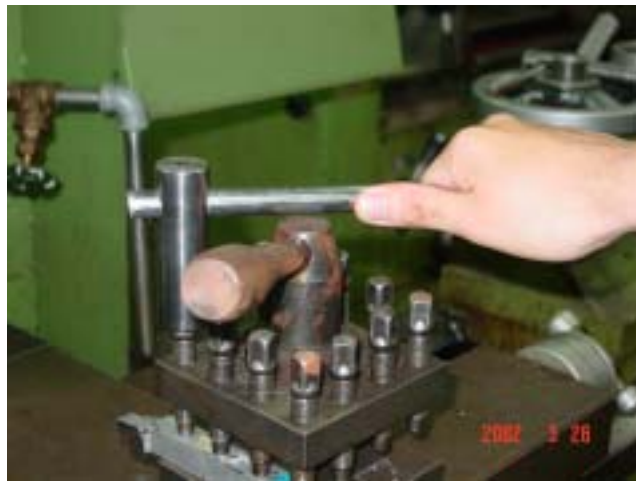
圖 8：改良手工具夾緊刀具時，較省力。
