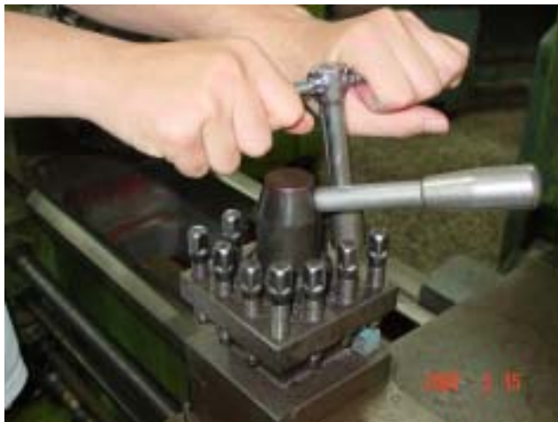
圖 2：刀架板手夾緊刀具時，需要很大的施力。
