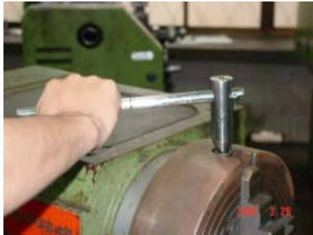
圖 7：改良手工具夾緊工件時，較省力。
