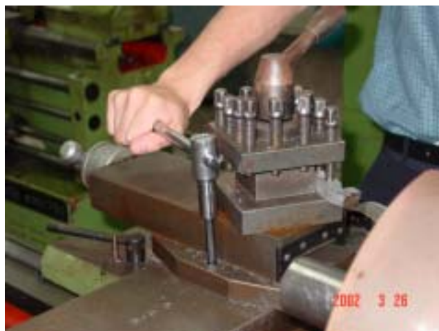
圖 9：改良手工具裝卸複式刀座時，較方便。
