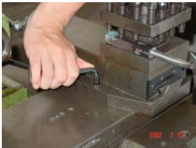
圖 3：六角板手裝卸複式刀座時，不方便。
