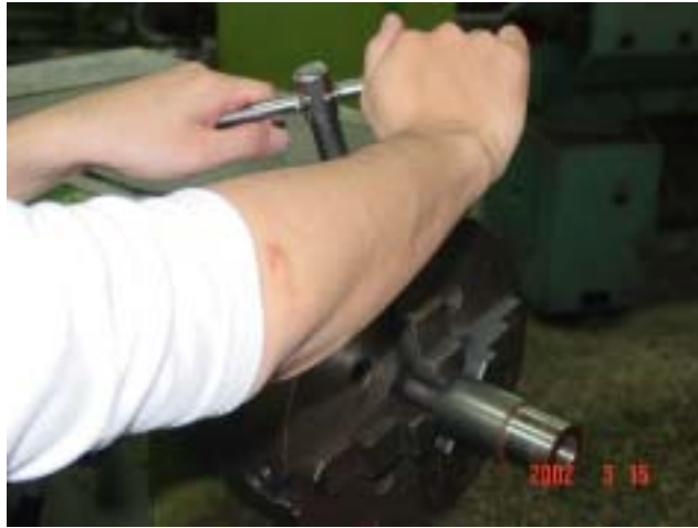
圖 1：夾頭板手夾緊工件時，需要很大的施力。
