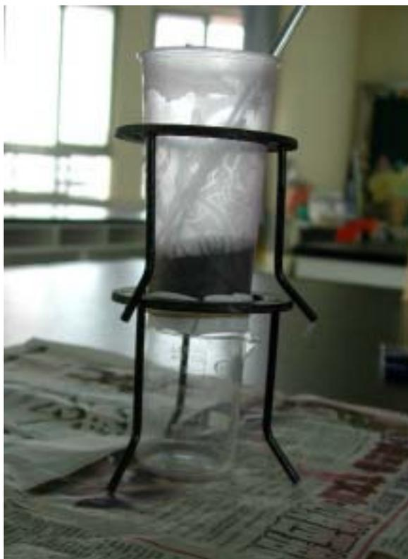
自製的排水裝置固定架
